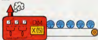
Cuando una variable numérica se dimensiona, sus elementos adoptan automáticamente el valor cero.
